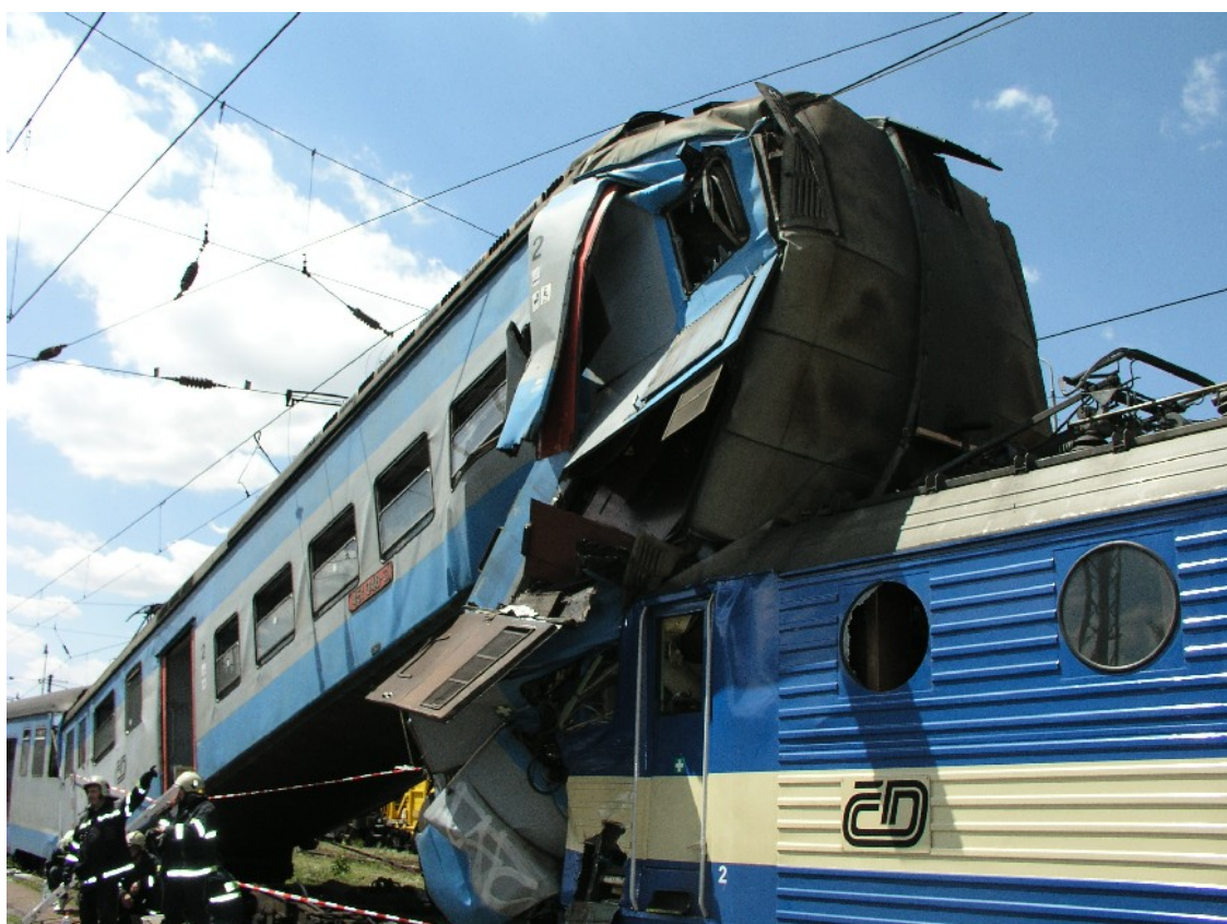
Foto 4: Deformované čelo HDV 451.048-3
