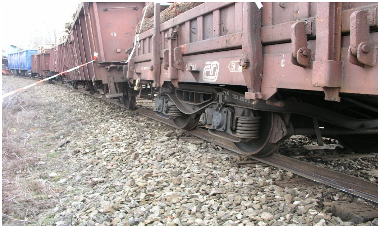
Foto 1: Konečné postavení vykolejených vozidel od konce vlaku
