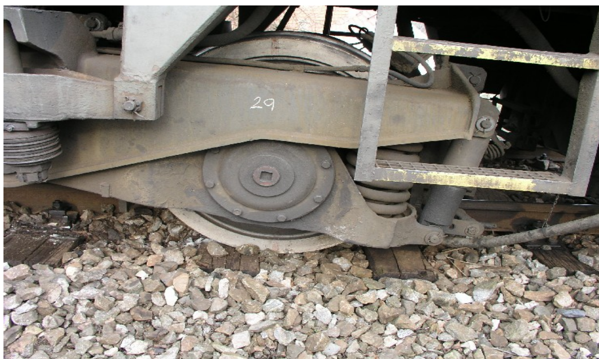
Foto 2: Vykolejený podvozek HDV 749.081-6
