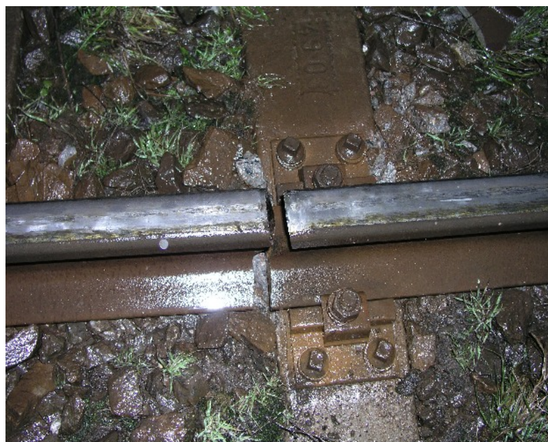
Foto 4: Druhý lom kolejnice, dle VUŽ iniciační, primární
