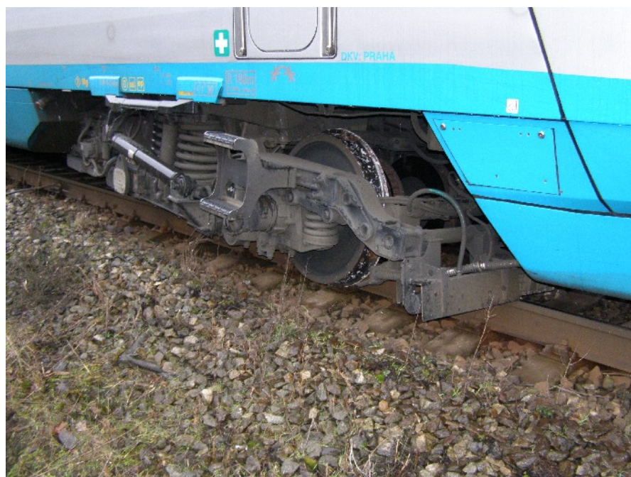
Foto 2: Detail vykolejeného podvozku
