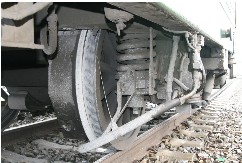
Foto 2: Písek na jízdnicích kol a na temeni kolejnice
