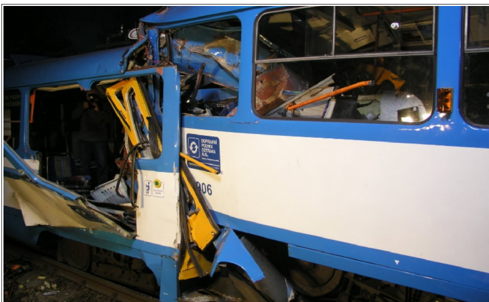
Foto 4: Konečné postavení DV MTV typů T3SU-CS, ev. č. 906 (linka č. 5, kurz 201) a K2G, ev. č. 810 (linka č. 5, kurz 402) po mimořádné události. Snímky dokumentují totální destrukci předních čel DV a rozsáhlé poškození vozových skříní zúčastněných tramvají.
