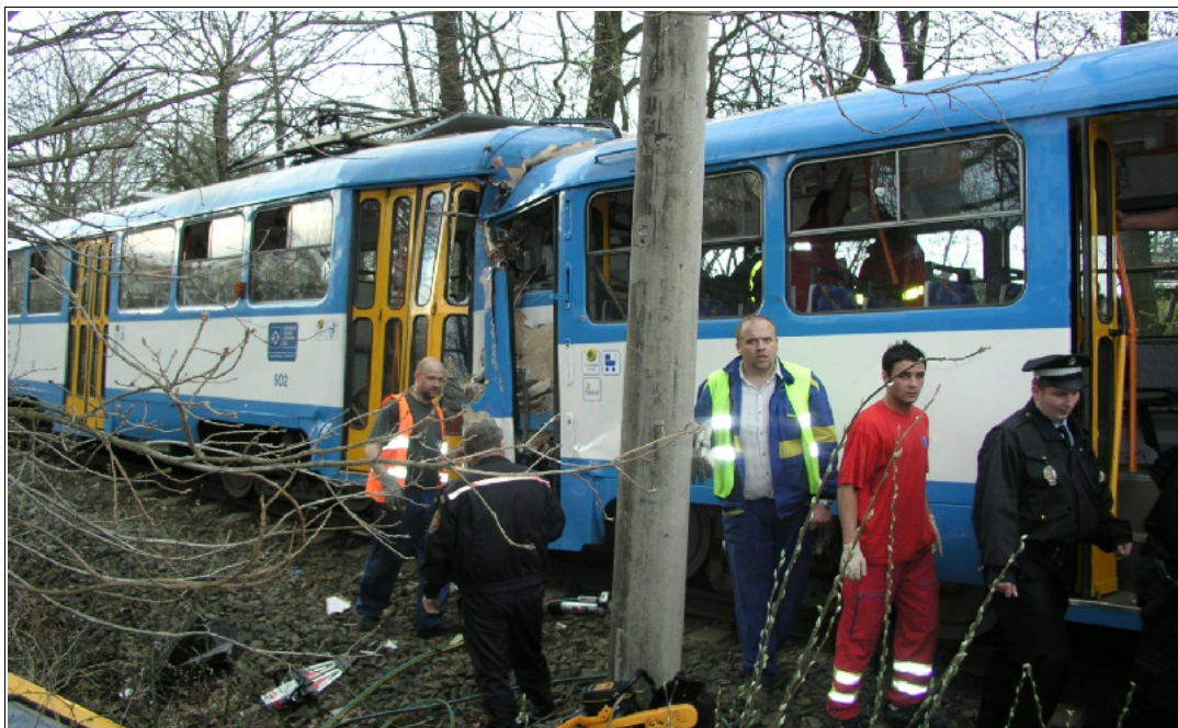
Foto 6: Konečné postavení DV tramvajového vlaku linky č. 5, kurz 201, sestávajícího z DV MTV typu T3SU-CS, ev. č. 906 (řídící) a ev. č. 902 (řízený) po mimořádné události. Z fotografie je patrné zaklínění DV způsobené najetím řízeného DV na řídící DV vlivem kinetické energie řízeného DV.
