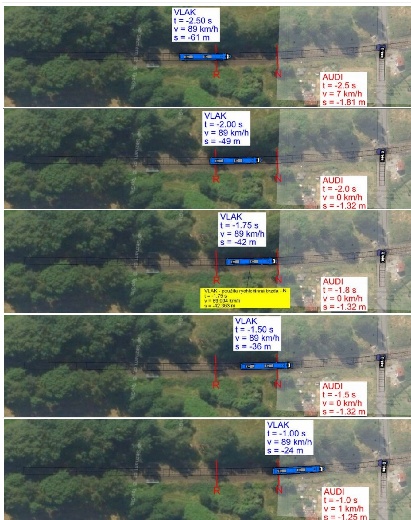
Obr. č. 20: Náhled simulace korelace (vzájemného) pohybu vlaku a 2. OA před střetnutím na ŽP P3277, kdy t = doba do srážky, v = rychlost vlaku/auta, s = zbývající vzdálenost do místa srážky Zdroj: Znalecký posudek
