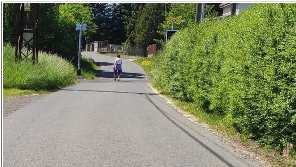
Obr. č. 4: Viditelnost (obou červených světel) výstražníku ve směru jízdy od centra Rumburku nebyla zajištěna na požadovaných 35 m Zdroj: DI
