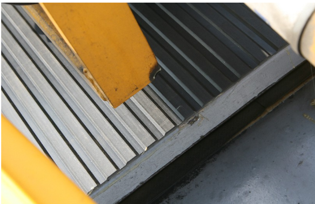
Foto 3: Poškozený rám pantografu v místě zkratu
